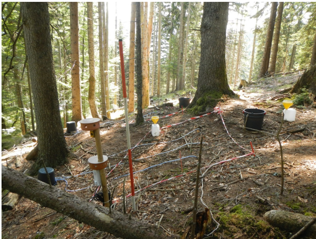
Abb. 21: Subplot auf einem untersuchten Tangelhumusstandort mit BNDS-Sammlern (weiße Kanister), Saugkerzen (helle Schläuche, die unter schwarzen Eimern mit den Sammelflaschen verschwinden), Streusammlern (schwarze Eimer) und den Loggern für die Lufttemperatur und die Messungen von Bodentemperatur und Bodenwasser (vorne links).
