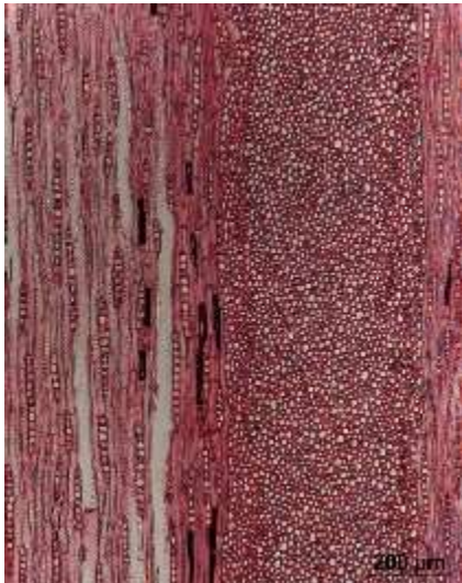
Abbildung 7: Mikroskopische Aufnahme des Tangentialschnitts von Eichenholz mit bildbestimmendem breitem Holzstrahl und kleinen, einreihigen Holzstrahlen. (Foto: Holzforschung München)
