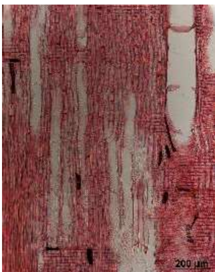
Abbildung 6: Mikroskopische Aufnahme des Radialschnitts von Eichenholz mit großen Frühholz- und kleinen Spätholzgefäßen. (Foto: Holzforschung München)
