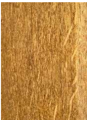
Abbildung 2: Makroskopische Aufnahme des Radialschnitts von Eichenholz. Besonders auffällig zeigen sich im Radialschnitt die als Spiegel bezeichneten und bildbestimmenden Holzstrahlen. (Foto: Holzforschung München)
