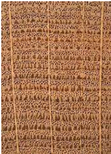
Abbildung 1: Makroskopische Aufnahme des Querschnitts von Eichenholz. Als charakteristische anatomische Merkmale sind die großen Frühholzgefäße, die radiale Ausrichtung der Spätholzgefäße sowie die breiten Holzstrahlen zu erkennen. (Foto: Holzforschung München)
