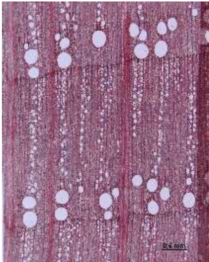
Abbildung 4: Mikroskopische Aufnahme des Querschnitts von Eichenholz mit breiten Jahrringen. Besonders deutlich ist die ausgeprägte radiale Anordnung der Spätholzgefäße zu erkennen. (Foto: Holzforschung München)
