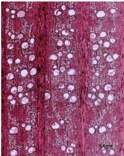
Abbildung 5: Mikroskopische Aufnahme des Querschnitts von Eichenholz mit engen Jahrringen. Im Gegensatz zum Holz mit breiten Jahrringen (Abbildung 4), ist die charakteristische anatomische Ausprägung des Spätholzes kaum zu erkennen. (Foto: Holzforschung München)
