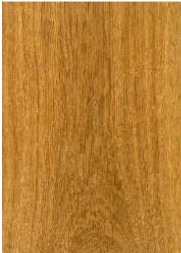
Abbildung 3: Makroskopische Aufnahme des Tangentialschnitts von Eichenholz. Im Tangentialschnitt findet sich die typische auffällige Fladerung durch den Wechsel des Früh- und Spätholz. (Foto: Holzforschung München)
