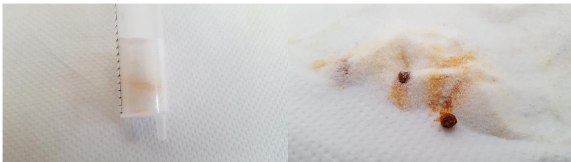
Abbildung 6: Einwegspritze mit korrodierten Eisenschroten (Rottweil Steel Game) in Quarzsand und Quarzwolle (links) sowie aus der Einwegspritze entfernte Schrote mit Quarzsand (rechts) nach dem letzten Beregnungstermin - Disposable syringe with corroded iron shot (Rottweil Steel Game) in quartz sand and quartz wool (left) and shot removed from the disposable syringe with quartz sand (right) after the last irrigation date.
