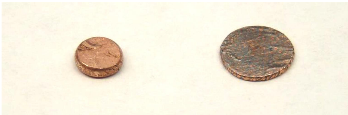
Abbildung 12: Schrote der als bleifrei deklarierten Kupferschrotpatrone FOB Sweet Copper nach Stauchversuch; links: Kupferschrot; rechts: kupferbeschichteter Bleischrot (aus Fäth et al. 2018a) - Shot of the FOB Sweet Copper cartridge (declared as lead-free) after crush test; left: copper shot; right: copper-coated lead shot (from Fäth et al. 2018a).
