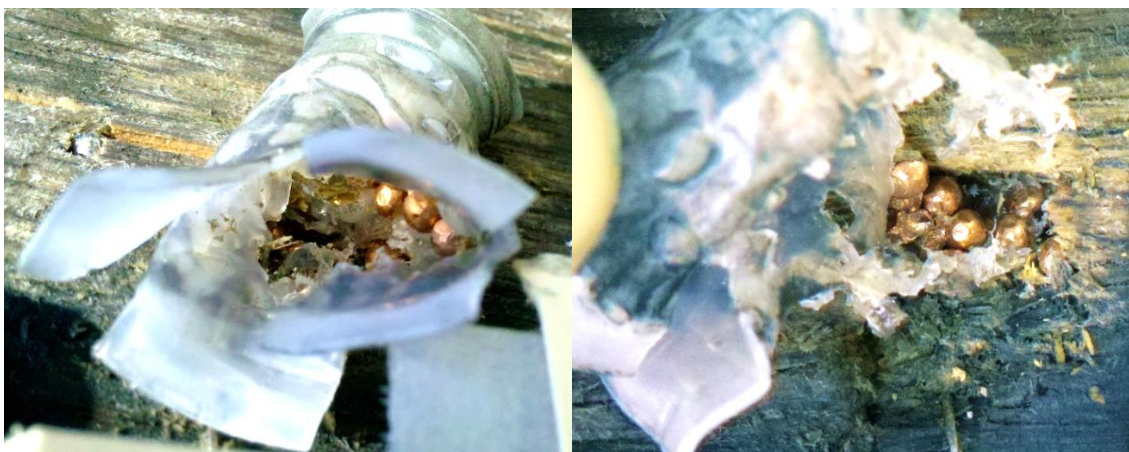
Abbildung 9: Im Becher zusammengebackene und in der Holzverschalung eingeschlagene Schrotklumpen nach Beschuss mit FOB Sweet Copper (aus Fäth et al. 2018b) – Stuck shot lump in the cup and the wood panel after shooting with FOB Sweet Copper (from Fäth et al. 2018b).
